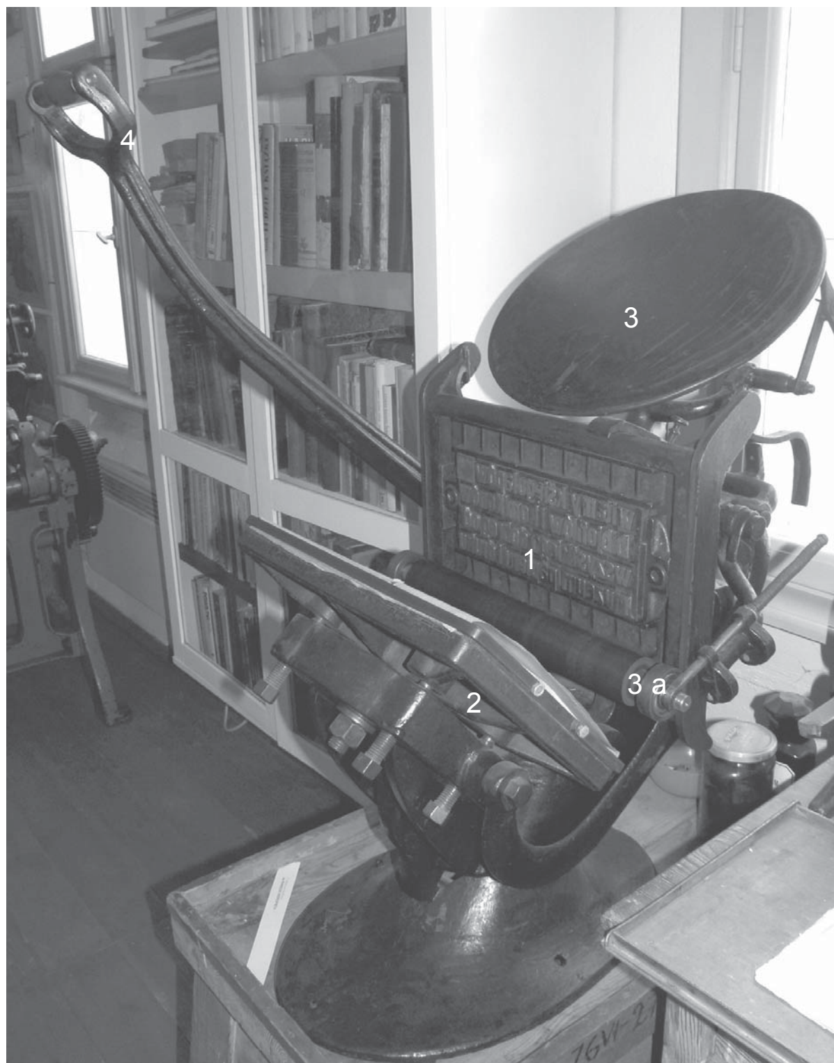
Maszyna drukująca dociskowa typograficzna typu „Boston” z napędem ręcznym – eksponat Muzeum Druku i Papieru w Łodzi. Fot. Grażyna Matuszak
