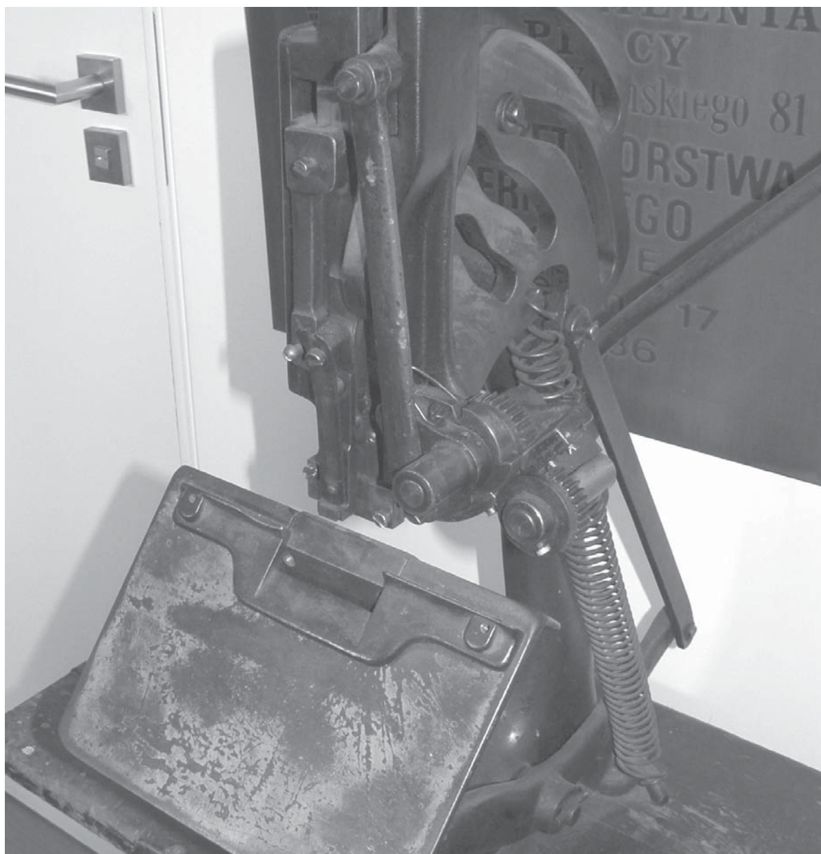
Zszywarka ręczna 1-głowicowa na zszywki metalowe, służąca m.in. do produkcji zeszytów - eksponat Muzeum Druku i Papieru w Łodzi. Fot. G. Matuszak
